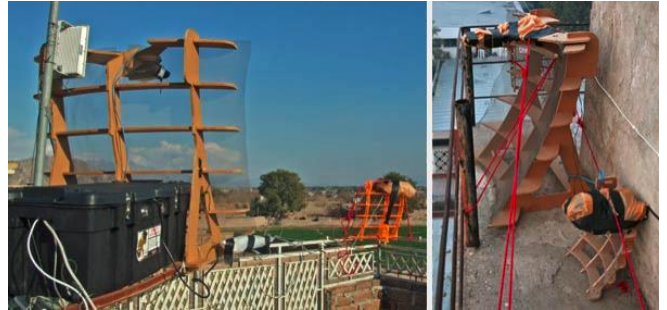
Fig.3 アフガニスタンのFabLab で製作されている木製長距離WiFiルーター「FabFi」(引用： http://fabfi.org/ )
