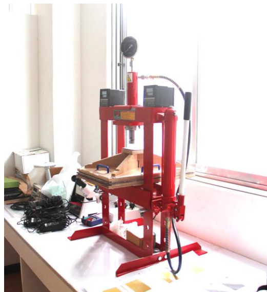
Fig.35 FabLab KannaiとFabLab Boholの共同開発を行った超小型リサイクル設備
