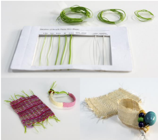
Fig.22 スーパーのレジ袋を溶かしてヒモ形状に再加工したもの(上)と、そのプラスチックヒモを縦糸に、毛糸を横糸にして編んだ布地(左下)と、プラスチックヒモを縦糸に、地元産ファイバーのラフィア素材を横糸にして織り込んだ布地(右下)
