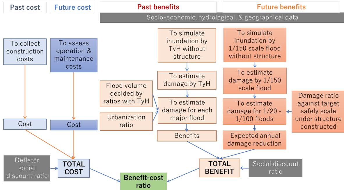
**Figure 6 : Calculation flow**
